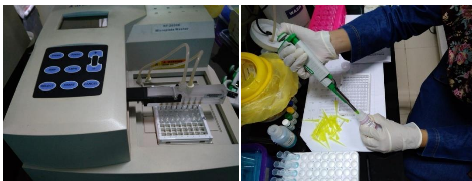
Pencucian dengan Microplate washer
