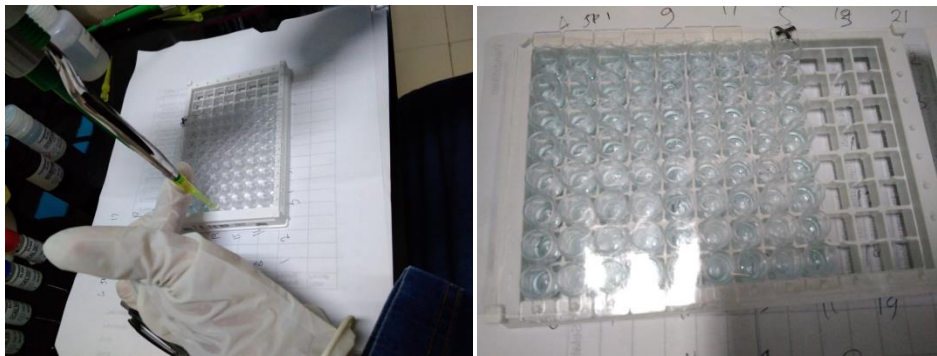
Pemipetan Sampel Ke dalam Microtiter plate dan ikubasi dalam suhu kamar
