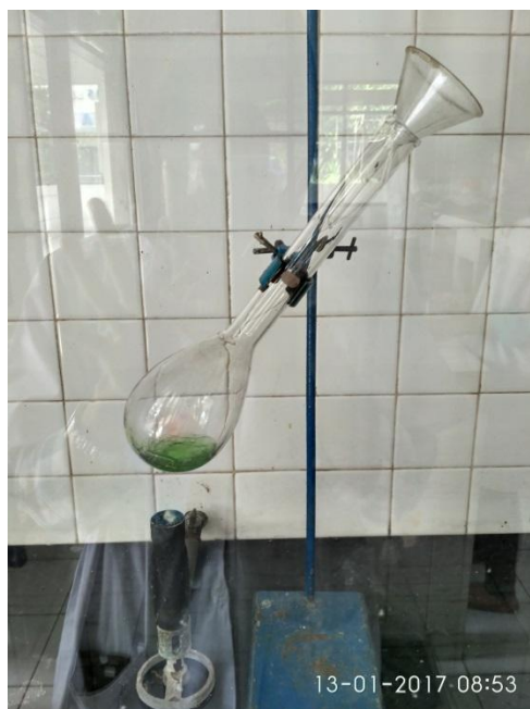
Proses Pemanasan di dalam lemari asam (Tahap Destruksi)
