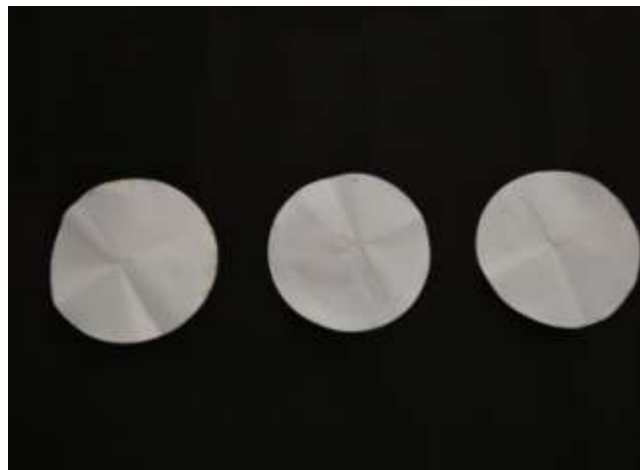
Hasil Penyaringan Limbah Cair Industri Tahu Untuk Pemeriksaan Kadar TSS
