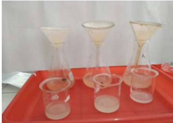
Poses Penyaringan Limbah Cair Industri Tahu Untuk Pemeriksaan Kadar TSS
