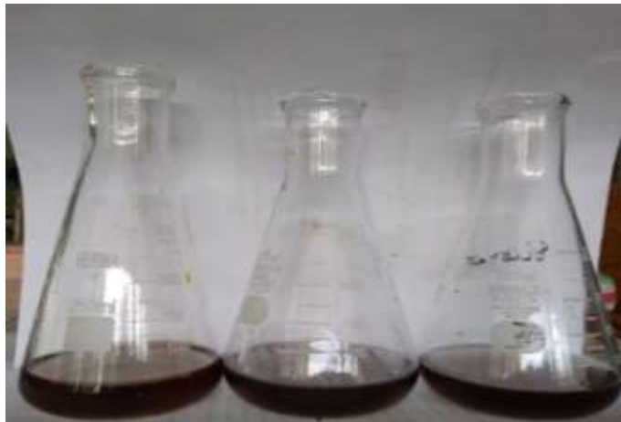
Standarisasi FAS \pm 0,1 N dengan \text{K}_2\text{Cr}_2\text{O}_7 0,2500 N
