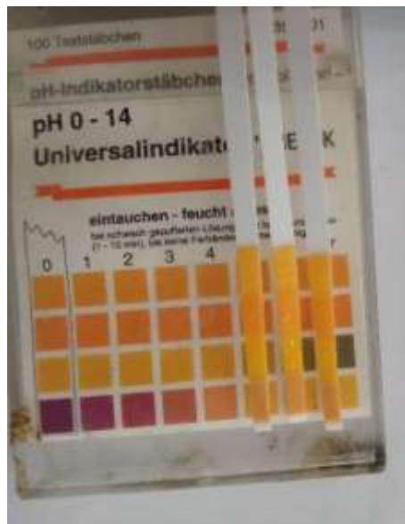
Hasil Pengukuran pH Limbah Cair Industri Tahu
