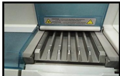
Tray berfungsi untuk tempat memasukkan strip yang berisi sampel dan reagen
