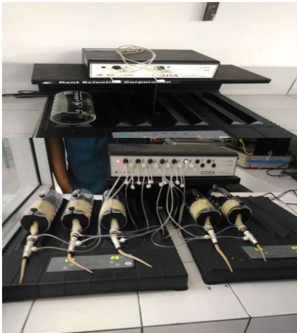
Lampiran 23. Gambar alat CODA untuk mengukur tekanan darah tikus
