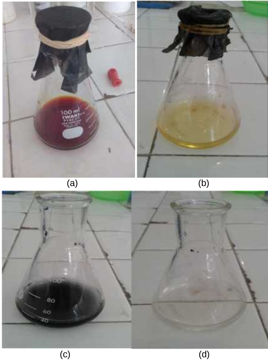
Gambar 8. Standarisasi \text{Na}_2\text{S}_2\text{O}_3 \pm 0,01 \text{ N} dengan \text{KIO}_3 0,01 \text{ N} (a) Sebelum Di Titrasi dengan \text{Na}_2\text{S}_2\text{O}_3 (b) Setelah Dititrasi Dengan \text{Na}_2\text{S}_2\text{O}_3 (c) Penambahan Amilum 1% (d) Titik Akhir Standarisasi
