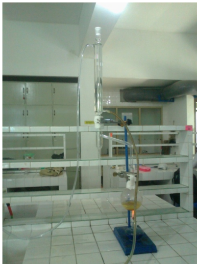
Gambar foto alat destilasi sterling bidwell
