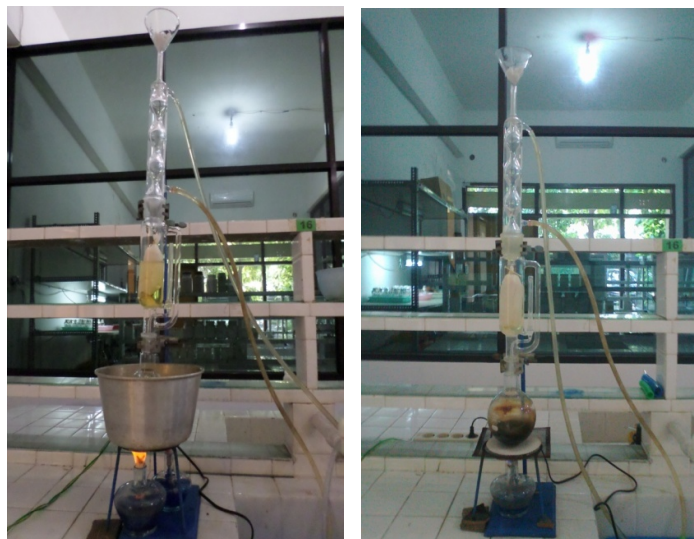
Gambar foto alat soxhletasi
