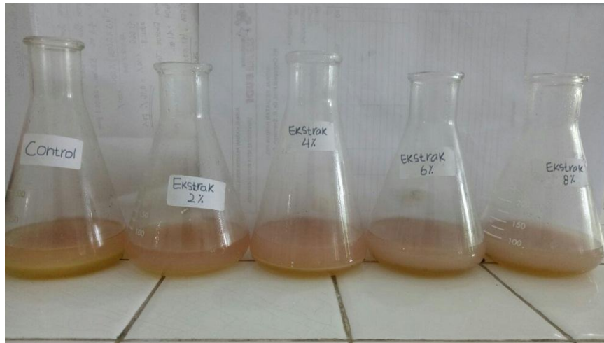
Hasil Akhir Titration Penentuan Kadar Asam Lemak Bebas Dengan Penambahan Ekstrak Teh Hijau
