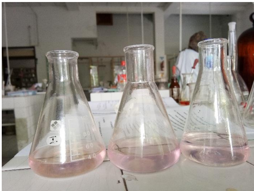
Titik Akhir Titrasi Standarisasi \text{NaOH} \pm 0,01 \text{ N} dengan Asam Oksalat 0,0100 \text{ N}
