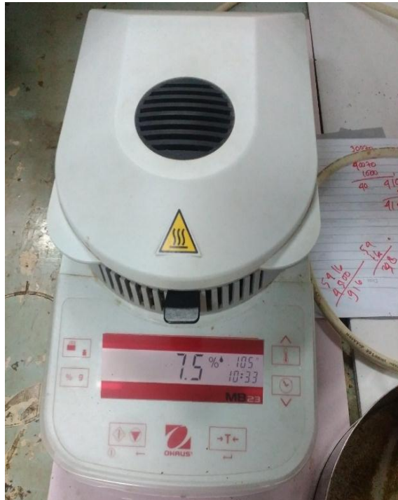
Proses Pengukuran Kadar Air Dengan Moisture Balance
