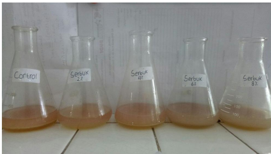
Hasil Akhir Titration Penentuan Kadar Asam Lemak Bebas Dengan Penambahan Serbuk Teh Hijau
