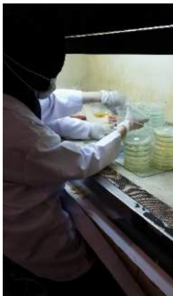
Penuangan Media ke cawan petri, pelabelan dan pembungkusan media
