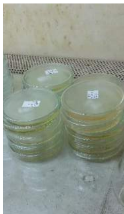
Penuangan Media ke cawan petri, pelabelan dan pembungkusan media
