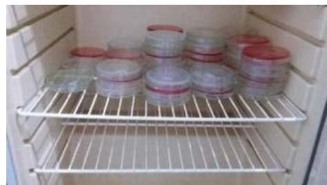
Diinkubasi dengan posisi terbalik selama 1x24 jam Pada suhu 37°C
