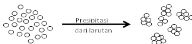
Gambar 1. Skema umum mekanisme teknologi bottom-up (Gupta dan Kompella 2006)
