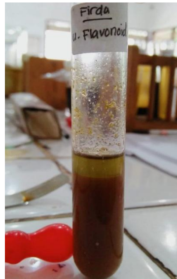
Uji tabung senyawa flavonoid
