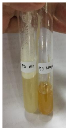
Uji tipe emulsi metode pengenceran dengan air
