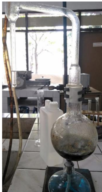
Proses uji kadar air ekstrak dengan alat Sterling-Bidwell
