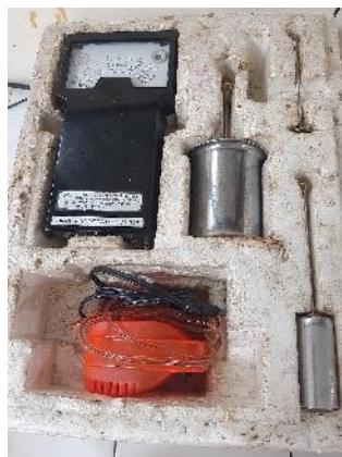
Uji viksositas dengan alat viskotester VT -04 RION
