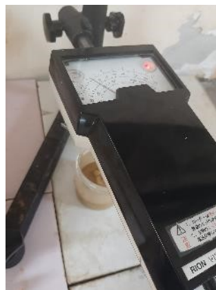
Uji viksositas dengan alat viskotester VT -04 RION
