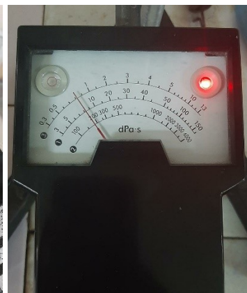
Uji viksositas dengan alat viskotester VT -04 RION
