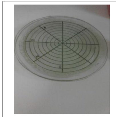
Uji Daya Sebar
