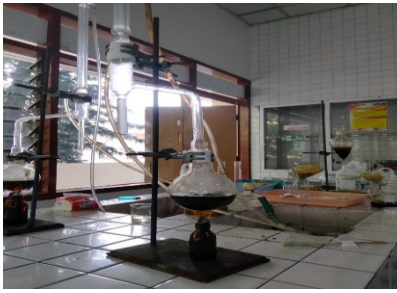
Rangkaian alat destilasi
