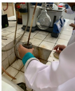
Pemekatan ekstrak dan fraksi dengan rotary evaporator
