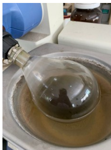
Pemekatan ekstrak dan fraksi dengan rotary evaporator
