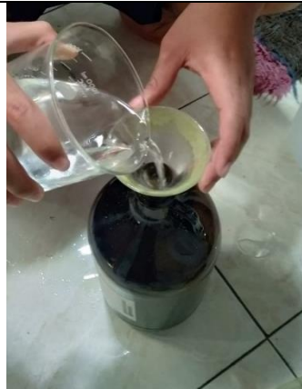
Penambahan Pelarut Pada Proses Maserasi
