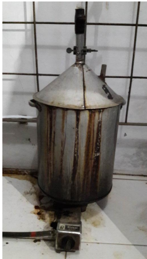
Alat destilasi Uap dan Air
