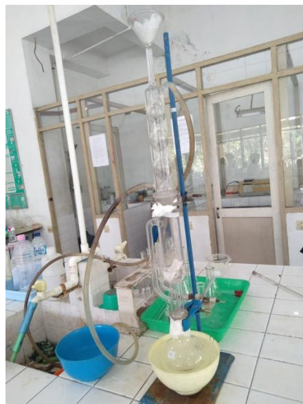
Gambar 18. Proses Ekstraksi Soxhlet
