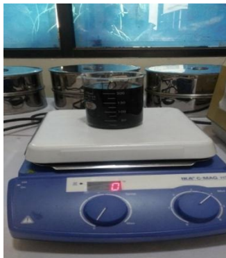
Arang dan Minyak Dicampur menggunakan Stirer
