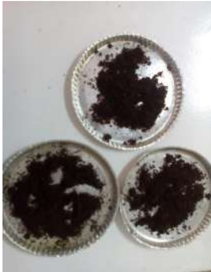
serbuk semut jepang setelah diuji kadar kelembaban dengan moisture balance
